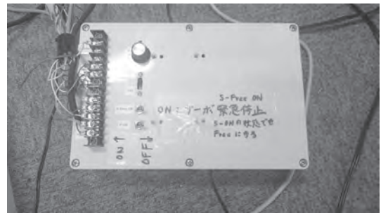
Fig. 6. 角度制御装置。
