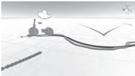
Fig. 12. 自転車モデルの走行している様子 (青：後輪軌跡，緑：前輪軌跡，赤：曲率中心軌跡)。
